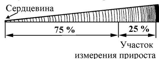
При использовании вариантов 1-3 значение прироста определяют в следующем порядке. Отмечают на радиусе точки начала и окончания участка измерения прироста с округлением результата до 1 мм. Число годичных слоев на участке измерения прироста подсчитывают по кольцам поздней древесины. Прирост для бревна вычисляют делением длины участка на число годичных слоев на нем. Результат округляют вверх до 1 мм.
