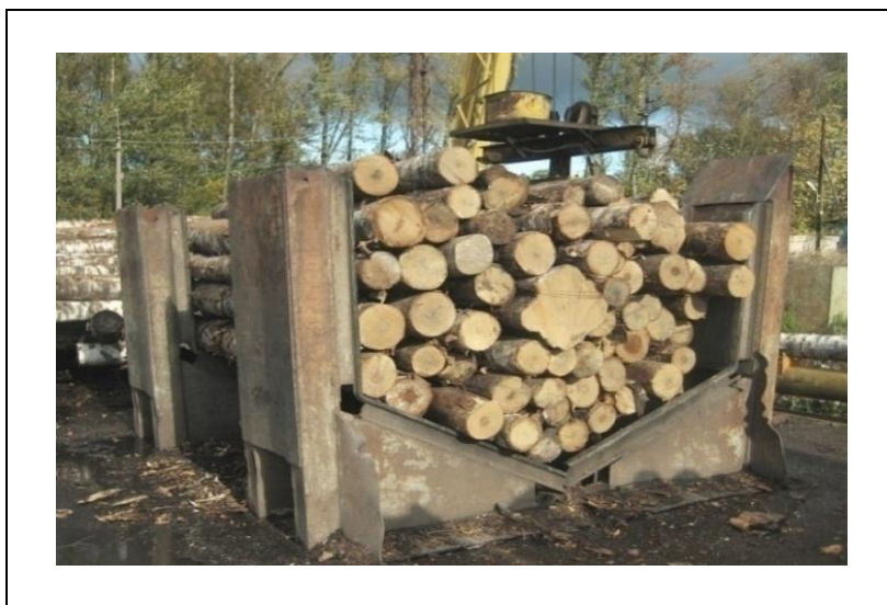
Рис. 18-1: Укладка в кассету фанерного кряжа для учёта по числу пакетов при передаче со склада в переработку
