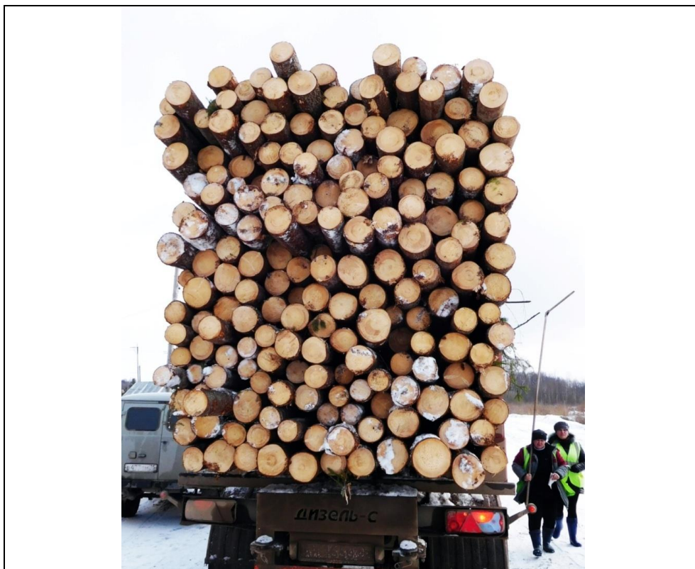
Рис. 16-5: ЗАО "Белый Ручей", 2016 год Пиловочник, ель, верхний диаметр 10-23 см. Ель. Длина 5,2 м. Измеренный коэффициент полндревесности штабеля 0,651
