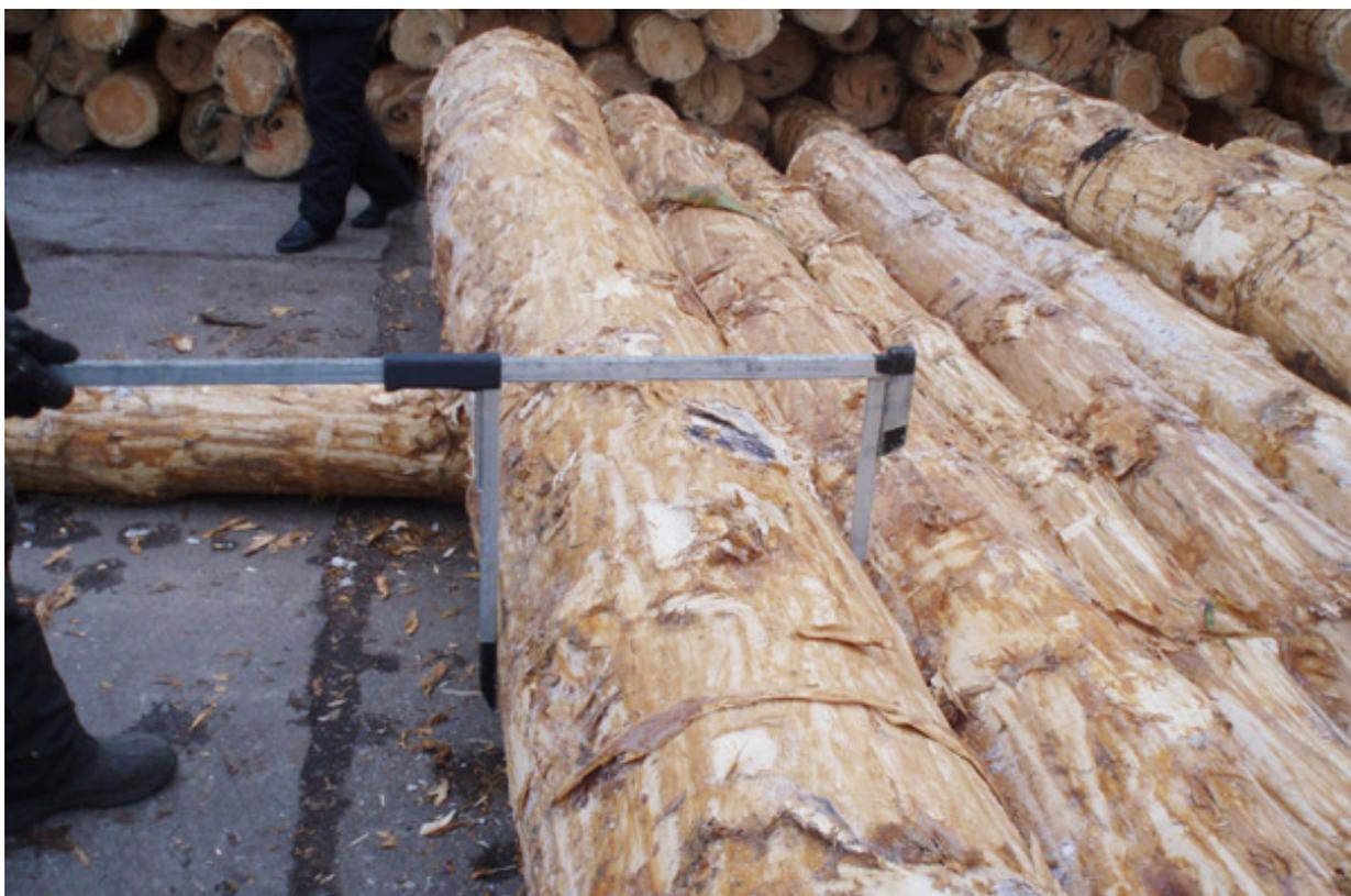
Измерение срединного диаметра измерительной вилкой
